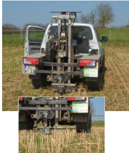
Vollautomatisiertes und standardisiertes  $N_{\min}$ -Bodenprobennahmegerät für eine 90 cm Durchwurzelungstiefe. Nitrat und Ammoniumstickstoff werden zum Zeitpunkt der Bodenprobennahme in der Bodenlösung analysiert.
