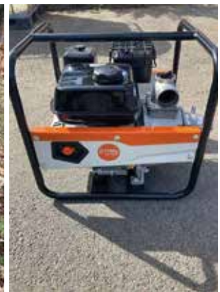
Foto rechts Wasserförderpumpe mit einer maximalen Abgabeleistung von 600 Liter/Minute.
