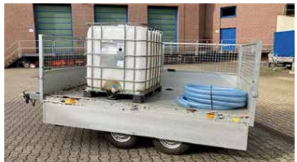
Foto IBC Container als Wasserfass mit Schlauchpaket
