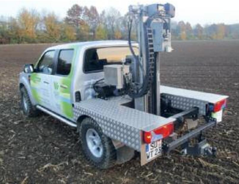
*Das Bodenprobenahmegerät ist fest auf dem Caddy installiert und arbeitet vollautomatisch. Die  $N_{min}$  Bodenprobe kann in Minutenschnelle erfolgen.*
