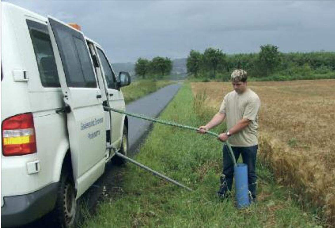
*Grundwasserprobennahme durch einen der Gewässerwarte.*
