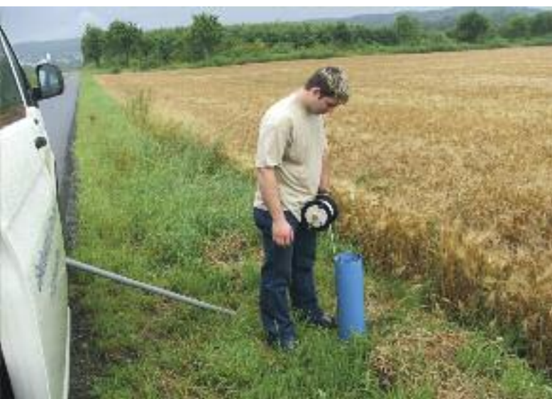
Grundwasserstandsmessung mit dem Lichtlot
