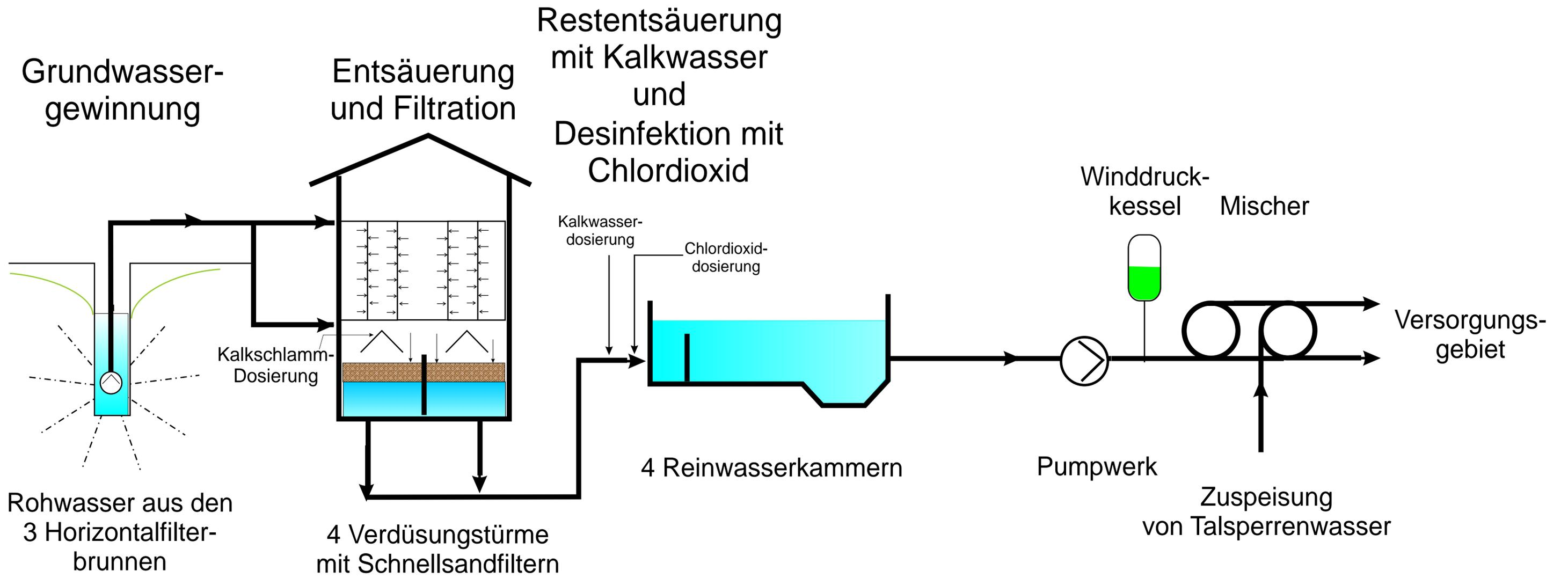
Schema der eingesetzten Aufbereitungsverfahren
